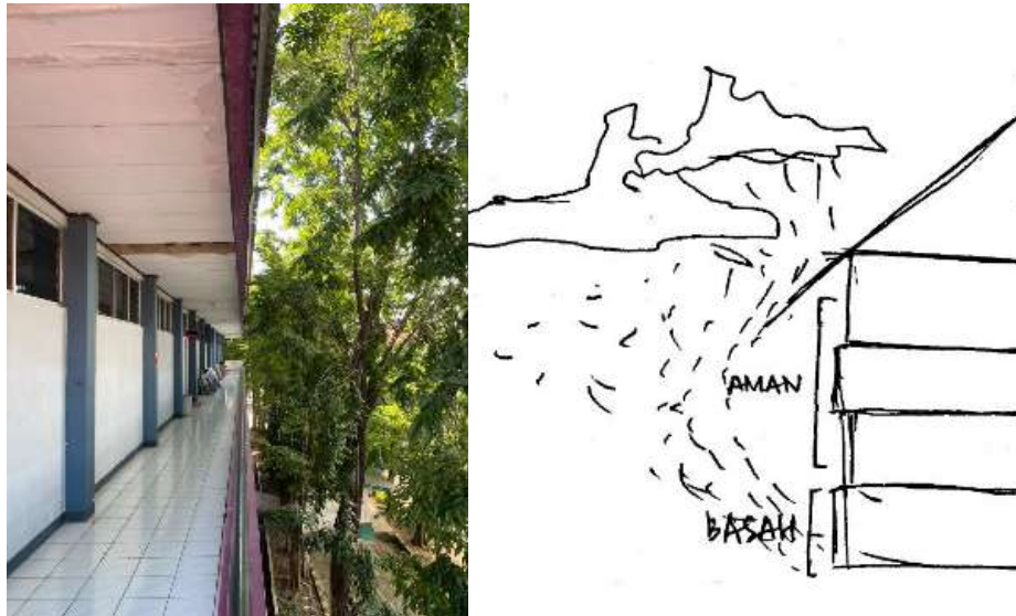
Gambar 20. Ilustrasi Pemanfaatan Overstek pada Atap (Sumber: dokumen dan analisis pribadi, 2022)
